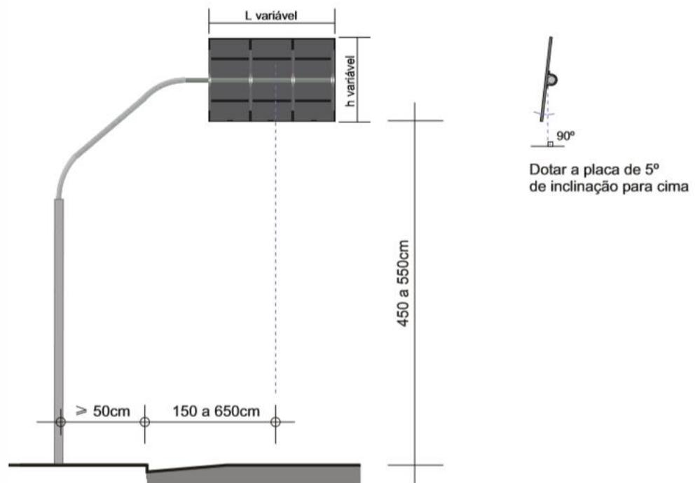
Implantação suportes coluna + braço projetado em área urbana. Material: metálico
